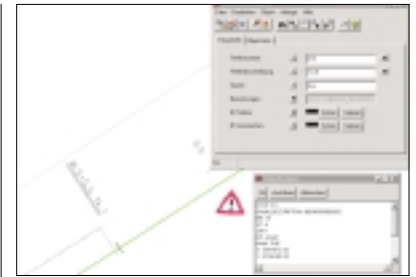
Daten, die bei der Analyse als fehlerhaft erkannt werden, erhalten ein Fehlersymbol. Gleiche Fehlertypen können gezielt en Bloc nachbearbeitet werden.
