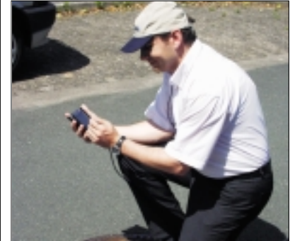
Der „iPaq“ ist an ein GPS zur lagegenauen Positionierung angeschlossen. Der GPS-Empfänger befindet sich in der Mütze.
