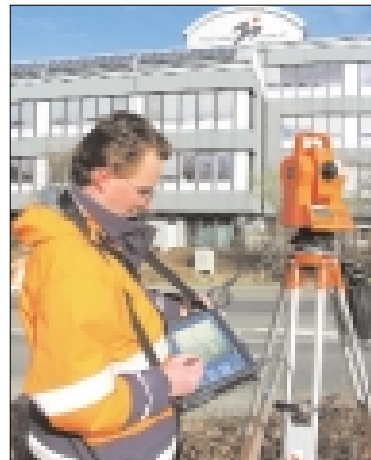
Der Tachymeter wird direkt aus der Software angesteuert. Die Erfassung und Änderung der Daten erfolgt bereits objektorientiert und minimiert dadurch die Nacharbeiten im Innendienst.
