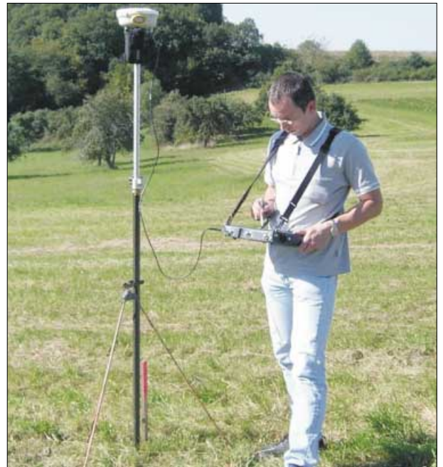
Der Vermesser hat mit dem Feldrechner die vollständige Kontrolle über die angeschlossenen Messsysteme, die Abarbeitung der vermessungstechnischen Abläufe mit visueller Kontrolle in der Grafik sowie die Erfassung vieler Attribute vor Ort, wo sie auch entstehen.
