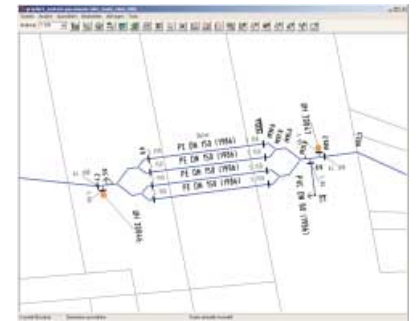
Dükerungen kommen bei der Untertunnelung von Flüssen zum Einsatz. Hier wird die Hauptwasserleitung in vier Leitungen aufgeteilt.
