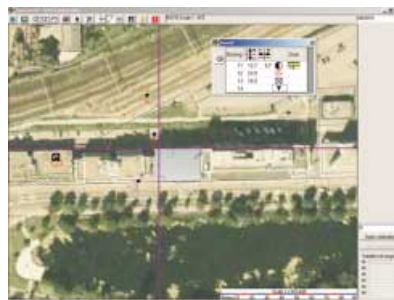
Inmeten: Auf dem Lageplan werden die Bohrpunkte eingetragen (GPS oder manuell).
