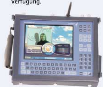
BSP: Die Daten von Bohrproben werden grafisch dargestellt und können mit GSM an den Projektleiter oder Berater gesandt werden.
