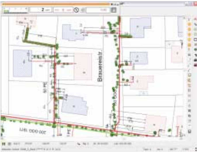
Ausschnitt eines Gasnetzes mit Bebauung und Behebungslinie des Gasspüers im Planwerk auf dem Pen-PC
