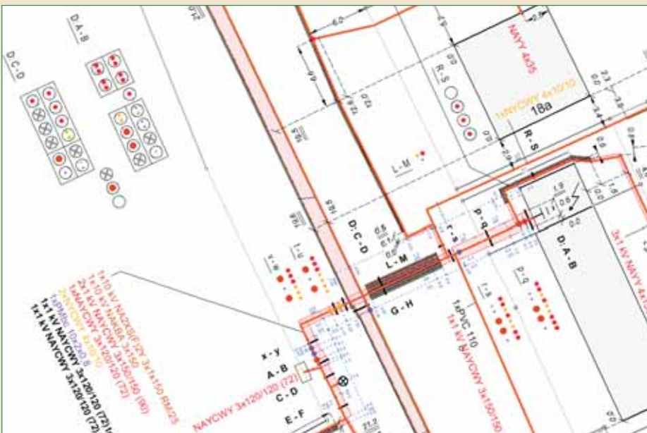
Trassendokumentation, Mehrfachbeschriftungen, Querschnittsdarstellung
