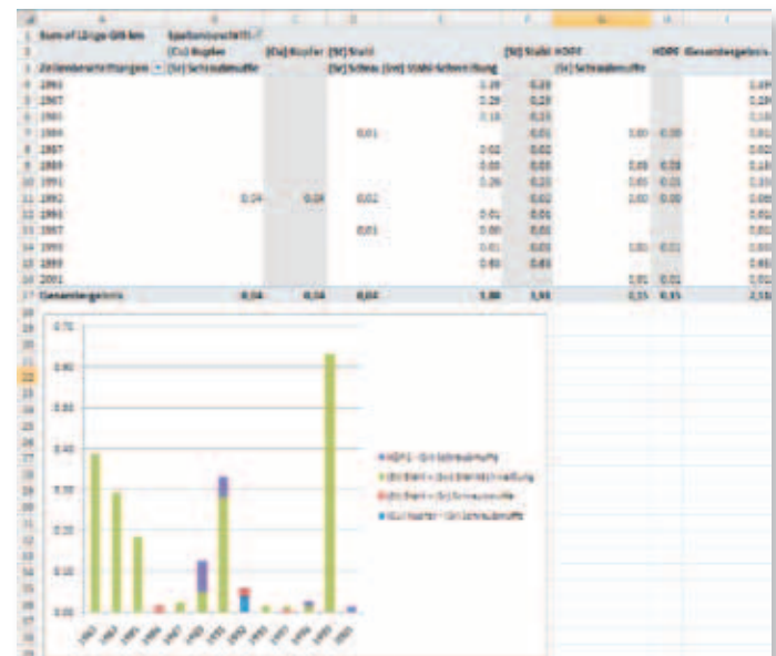
Report Verlegezeiträume für unterschiedliche Rohrleitungsmaterialien und Verbindungsarten nach Anhang B des DVGW-Arbeitsblatts G401
