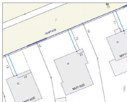
Erzeugung einer Parallelbemaßung mit festem Abstand per Knopfdruck aus dem Trail des Kabels.
