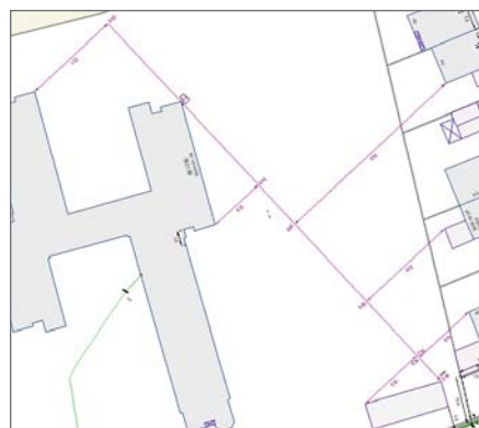
Ähnlich einfach ist die Erzeugung einer Orthogonalbemaßung: Der erste und der zweite Trailpunkt werden als Maßlinie interpretiert, auf die alle weiteren Trailpunkte aufgewinkelt werden.
