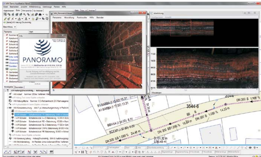
Ansteuerung eines IBAK-Panorama-Videos direkt zu einem selektiertem Schaden im Smallworld GIS
