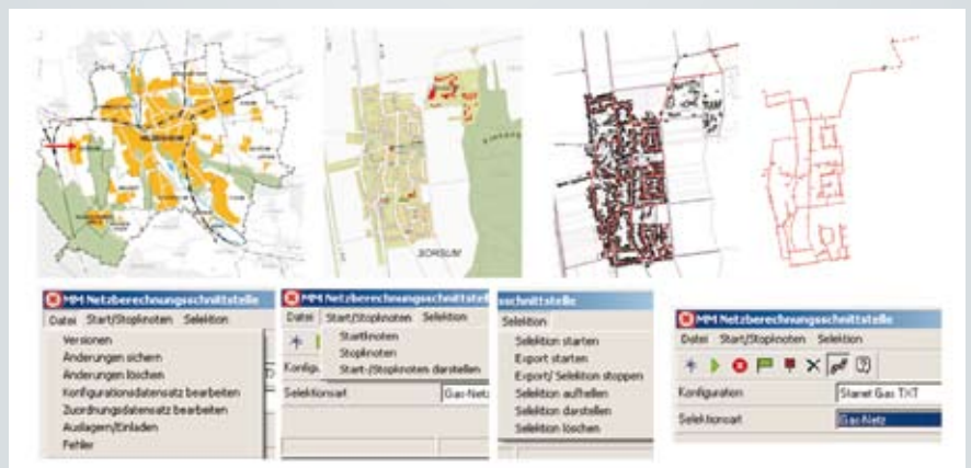
Im Smallworld GIS wird die Netzberechnung vorbereitet, die Daten werden aufbereitet, und in STANET wird mit aktuellen Daten gerechnet.
