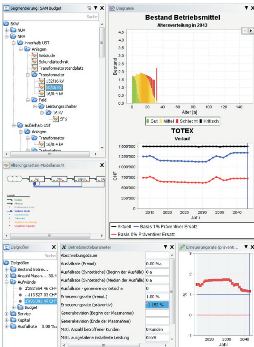
Das Vesta Decision Support System ermöglicht die Simulation von Assets sowie der künftigen Entwicklung ihrer technischen und kaufmännischen Kennzahlen, hier: fiktive Zahlenbeispiele für Transformatoren.
