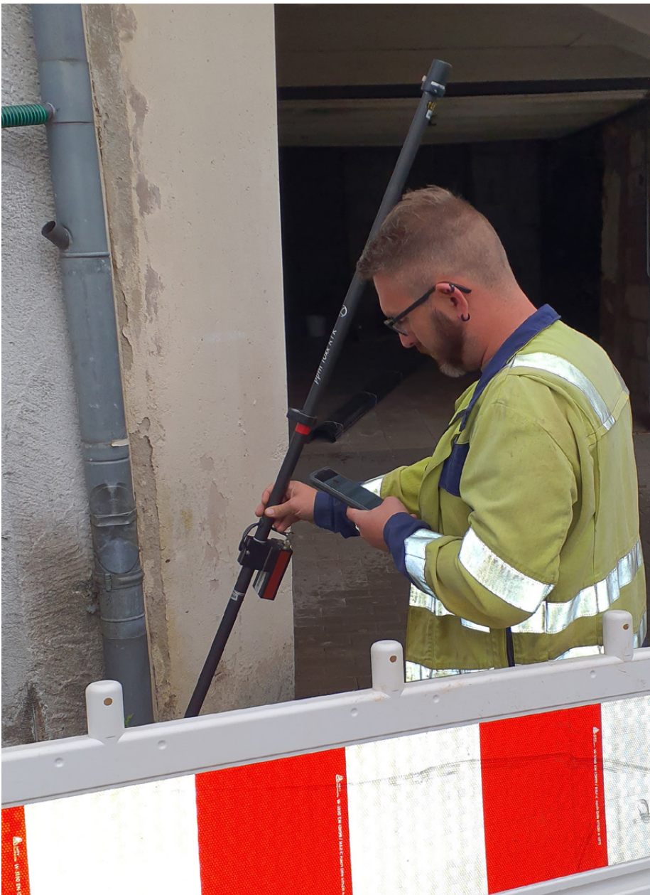
Durch den Einsatz eines Messstabs mit Neigungssensor lassen sich schräge Messungen durchführen. So werden Abschattungen, zum Beispiel direkt am Gebäude, umgangen.
