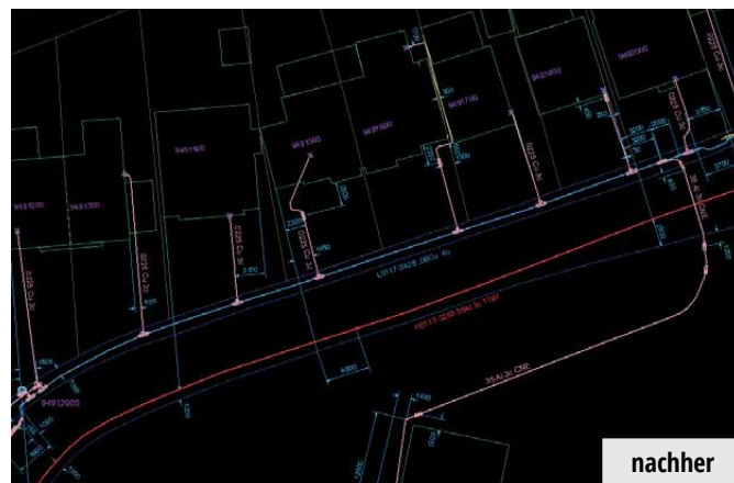
Das geübte Auge eines GIS-Experten erkennt es sofort: Die Hauptleitungen (blau und rot) lagen vorher zum Teil deutlich neben dem Straßenzug und auch bei den Hausanschlussleitungen mit ihren Bemaßungen waren Korrektur erforderlich.
