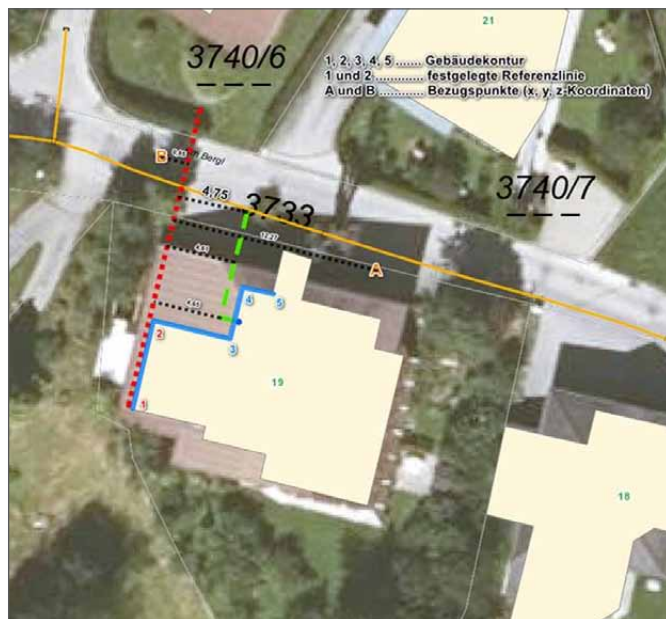
Beispiel für einen Hausanschluss: Von der Gasleitung (gelb) wurde ein neuer Hausanschluss (grün) abgezweigt und eingemessen. Dabei sorgt die Referenzlinie (rot) für eine korrekte Einmessung. Zusätzlich dienen die Bezugspunkte A und B der späteren Transformation der relativen Lagedaten aus NAVA in das absolute Koordinatensystem zur lagerichtigen Darstellung im NIS.
