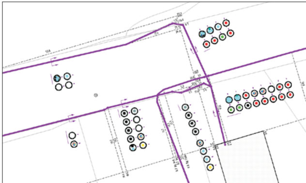
Grabenprofil mit mehrlagigem Schutzrohrsystem und Belegung mit unterschiedlichen Medien, unter anderem LWL, Strom-Mittelspannung und Strom-Niederspannung.
