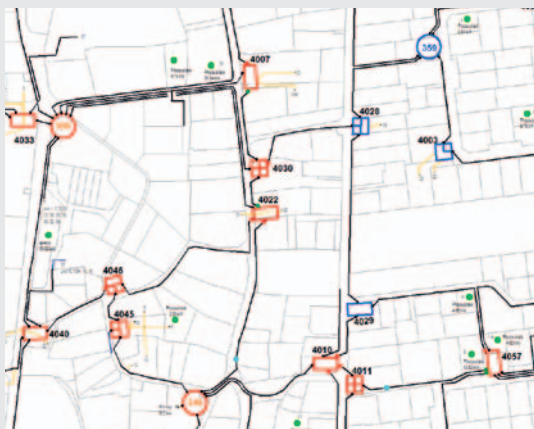
Netzplan mit Stromstationen, Kabelverteilern, Schaltzuständen und Einspeisern
