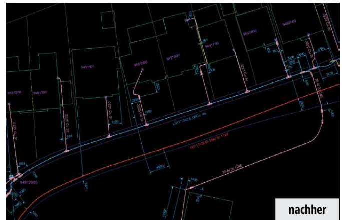
Das geübte Auge eines GIS-Experten erkennt es sofort: Die Hauptleitungen (blau und rot) lagen vorher zum Teil deutlich neben dem Straßenzug und auch bei den Hausanschlussleitungen mit ihren Bemaßungen waren Korrektur erforderlich.
